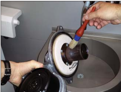
Obr. 1 Čištění hořáku spalovací komory
